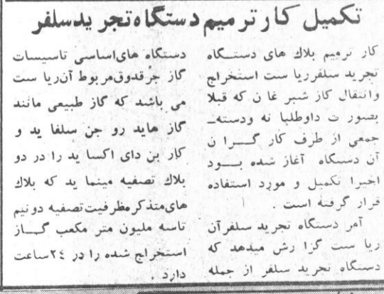
دستگاه های اساسی تاسیسات گاز جرقوق مربوط آن ریاست می باشد که گاز طبیعی مانند گاز هایدروجن سلفاید و کاربن دای اکساید را در دو بلاک تصفیه مینماید که بلاک های متذکره ظرفیت تصفیه دو نیم تاسه میلیون متر مکعب گاز استخراج شده را در ۲۴ ساعت دارد.
